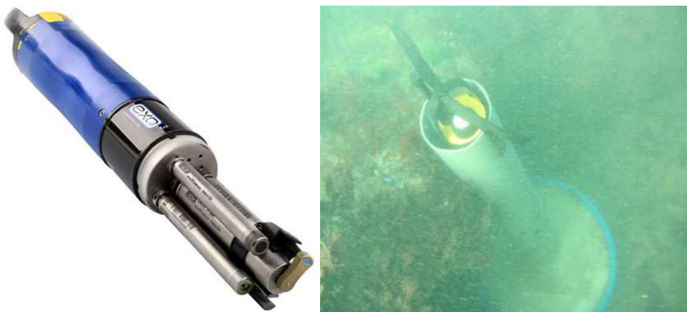
Figure 6 : Sonde EXO 3, Xylem telle qu'affichée par le fabricant (à gauche), et la sonde sur le site de restauration fixée avec une ancre (à droite).
