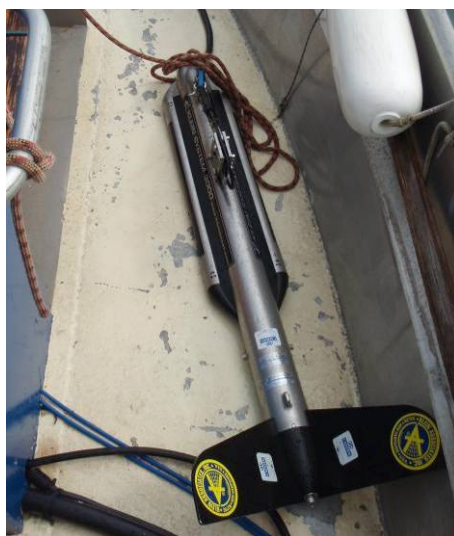
Figure 39. Le sonar Klein 3000 à balayage latéral utilisé pour l'étude.
