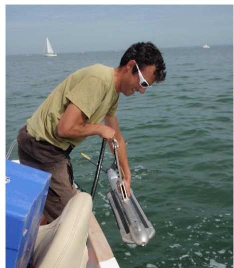
Figure 39. Le sonar Klein 3000 à balayage latéral utilisé pour l'étude.
