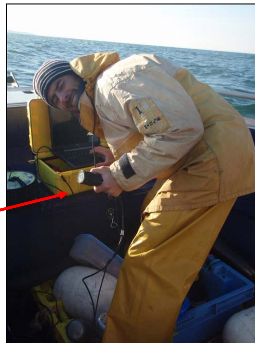
Figure 40. Rendu instantané de l'image du sonar à bord et pointage des zones intéressantes à visualiser à l'aide de la caméra vidéo sous-marine, pour déterminer la nature de la couverture algale.
